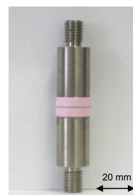
Abb. 4-7: mit Knochenzement verklebtes Stempelpaar
