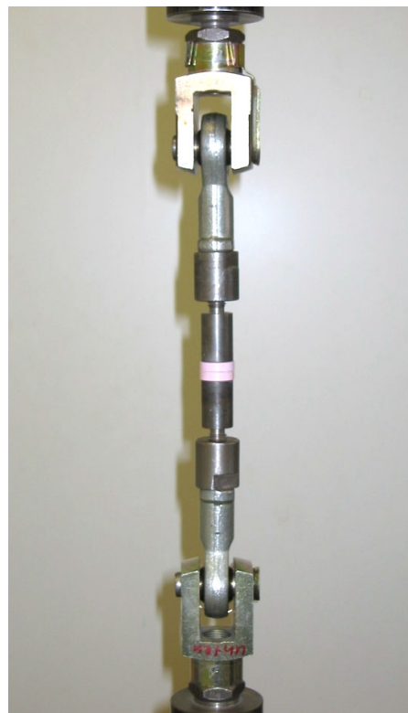
Abb. 4-8: links: Instron-Zugprüfmaschine mit eingespannter Probe, rechts: Ausschnitt
