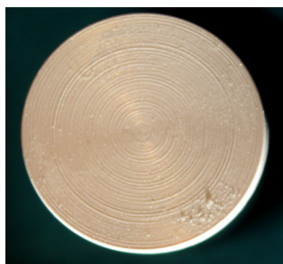
Bild 6-12: Bruchfläche von BIOLOX® delta / Palamed® G, mit unbehauelter Keramikoberfläche
