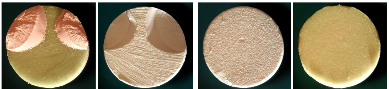
Bild 6-6: Bruchflächen von BIOLOX® delta / Palamed® G, beschichtete Keramikoberfläche mit Ausbrüchen
