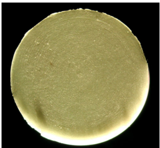
Bild 6-14: Bruchfläche von BIOLOX® delta / Palamed® G, mit nach dem Sintern sandgestrahlter Keramikoberfläche
