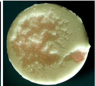
Bild 6-15: Bruchfläche von BIOLOX® delta / Palamed® G, mit nach dem Sintern sandgestrahlter und silnisierter Keramikoberfläche
