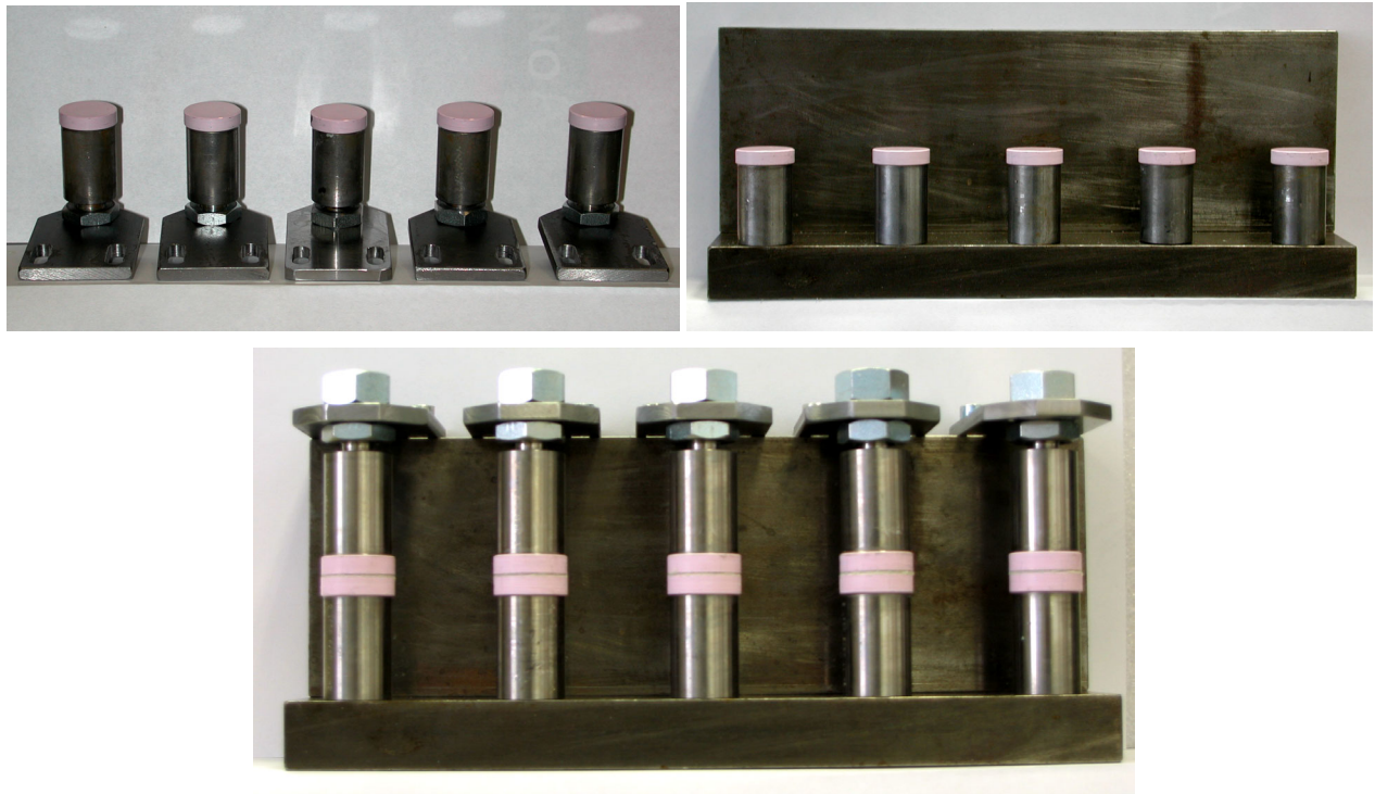
Abb. 4-5: Knochenzementklebevorrichtung, oben rechts: obere Stempel, oben links: untere Stempel, unten: gesamte Vorrichtung mit paarweise zementierten Stempeln
