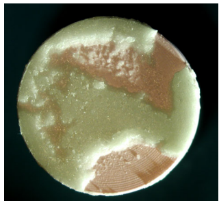
Bild 6-13: Bruchfläche von BIOLOX® delta / Palamed® G, mit unbehauelter u. silnisierter Keramikoberfläche
