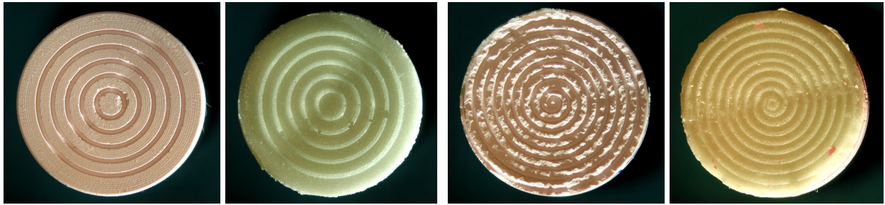
Bild 6-2: Bruchflächen von BIOLOX® delta / Palamed® G, Keramikoberfläche mit Drehrillen
