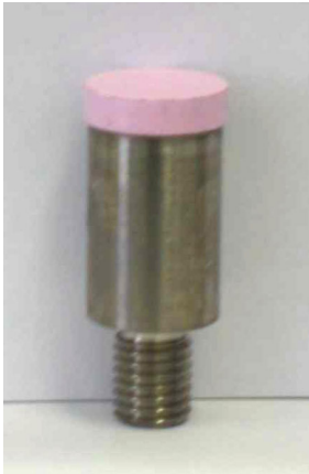
Abb. 4-2: auf Stahlstempel aufgeklebtes Keramikplättchen
