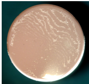
Bild 6-10: Bruchfläche von BIOLOX® delta / Palamed® G, mit polierter Keramikoberfläche
