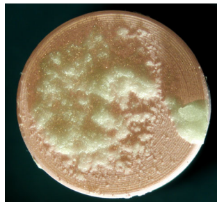
Bild 6-15: Bruchfläche von BIOLOX® delta / Palamed® G, mit nach dem Sintern sandgestrahlter und silnisierter Keramikoberfläche
