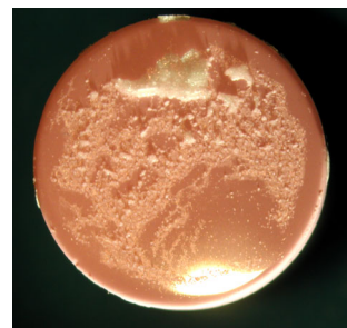
Bild 6-11: Bruchfläche von BIOLOX® delta / Palamed® G, mit polierter und silanisierter Keramikoberfläche
