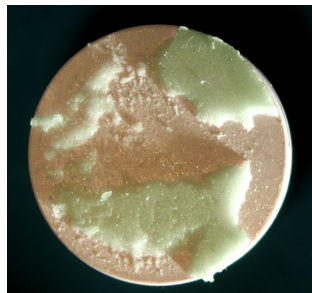
Bild 6-13: Bruchfläche von BIOLOX® delta / Palamed® G, mit unbehauelter u. silnisierter Keramikoberfläche
